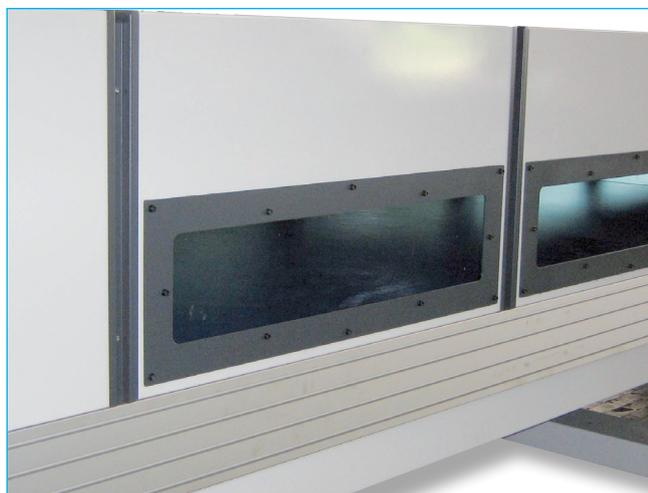
Apertura per controllo d'ispezione aria - Opening for inspection
