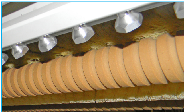
Rullo di contrasto oscillante e ugelli aria per pulizia spazzola Oscillating roller and air nozzles for brush cleaning
